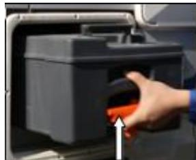
4、将排污管转到如图排污位置，打开盖子倾斜废水箱，同时按下空气减压阀，排秽物会缓缓流出；
