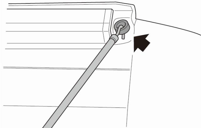
3、将遮阳棚摇杆折成图中样子，控制遮阳棚摇杆和车体角度在 30° 以内，并逆时针旋转，打开遮阳棚（最大伸出距离 2 米（短轴），2.5 米（长轴））。建议当遮阳棚展开 1 米左右后，将遮阳棚支撑杆从遮阳棚里取出。
