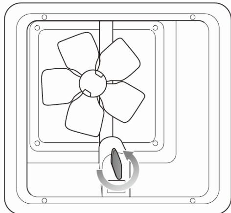
2、如下图所示，排气扇开关有 3 个档位（包括排气扇逆时针旋转，顺时针旋转，停止转动），可根据需要进行选择。
