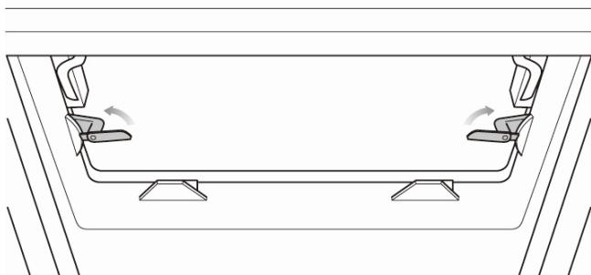
2、将支撑杆推至车后固定处（按箭头方向往窗后推进 90°）。
