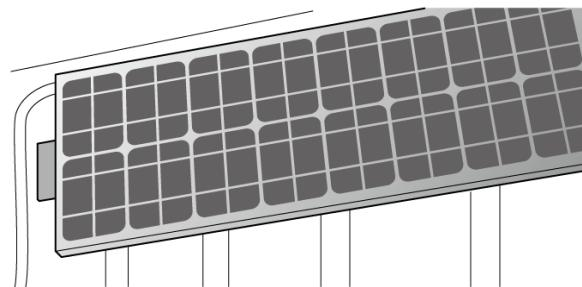
车辆采用的太阳能电池板为玻基（单晶硅），在阳光直射时发电效率最高。
