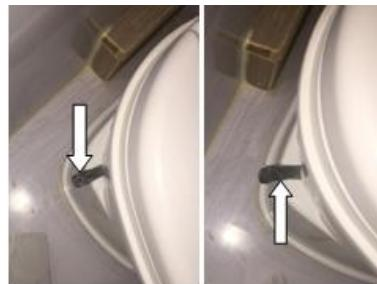
2、插入钥匙旋转，两手同时向下按钥匙孔和下孔，打开废水箱；
