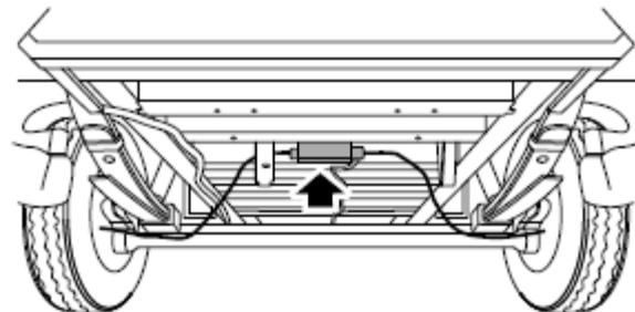
电子驻车制动（EPB）位于车辆后桥中上部，如果电子驻车制动（EPB）用正常的操作无法释放，可以用如下方法释放。
