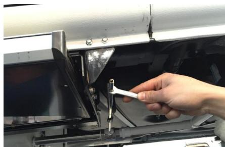
利用随车工具里开口扳手夹紧排水阀手柄逆时针打开排水阀，放水完毕后将阀门复位。
