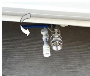
将水箱出水口处阀门沿箭头方向逆时针旋转打开阀门，放水完毕后将阀门复位。
