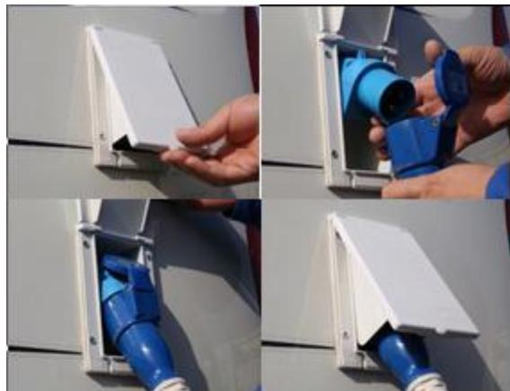
2、插好外接市电后再推上外部电源开关，如果市电正常输入至车内，触控屏逆变器按键区域上充电指示灯亮起和逆变器按键区域右下角市电插头图标亮起。
