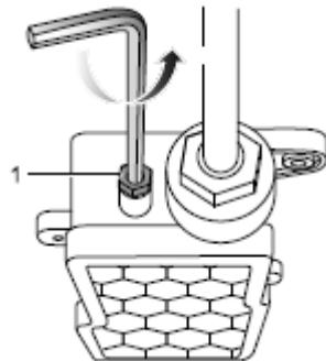
3、用内六角扳手插入紧急释放端口。顺时针旋转内六角扳手直至从车后端可以推动车辆为止（一般而言 100 圈左右即能达到驻车松开状态）。
