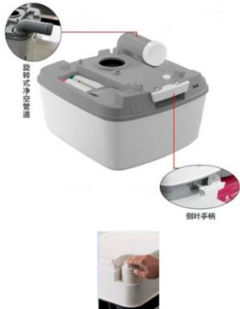
倾倒：废水箱满后，按分离步骤分离座便器（需将侧叶手柄推严）。将废水箱提到厕所或指定排污点，将排污管转到关口向上，打开盖子，倾斜废水箱，同时按下空气减压阀，排泄物会缓缓流出。
